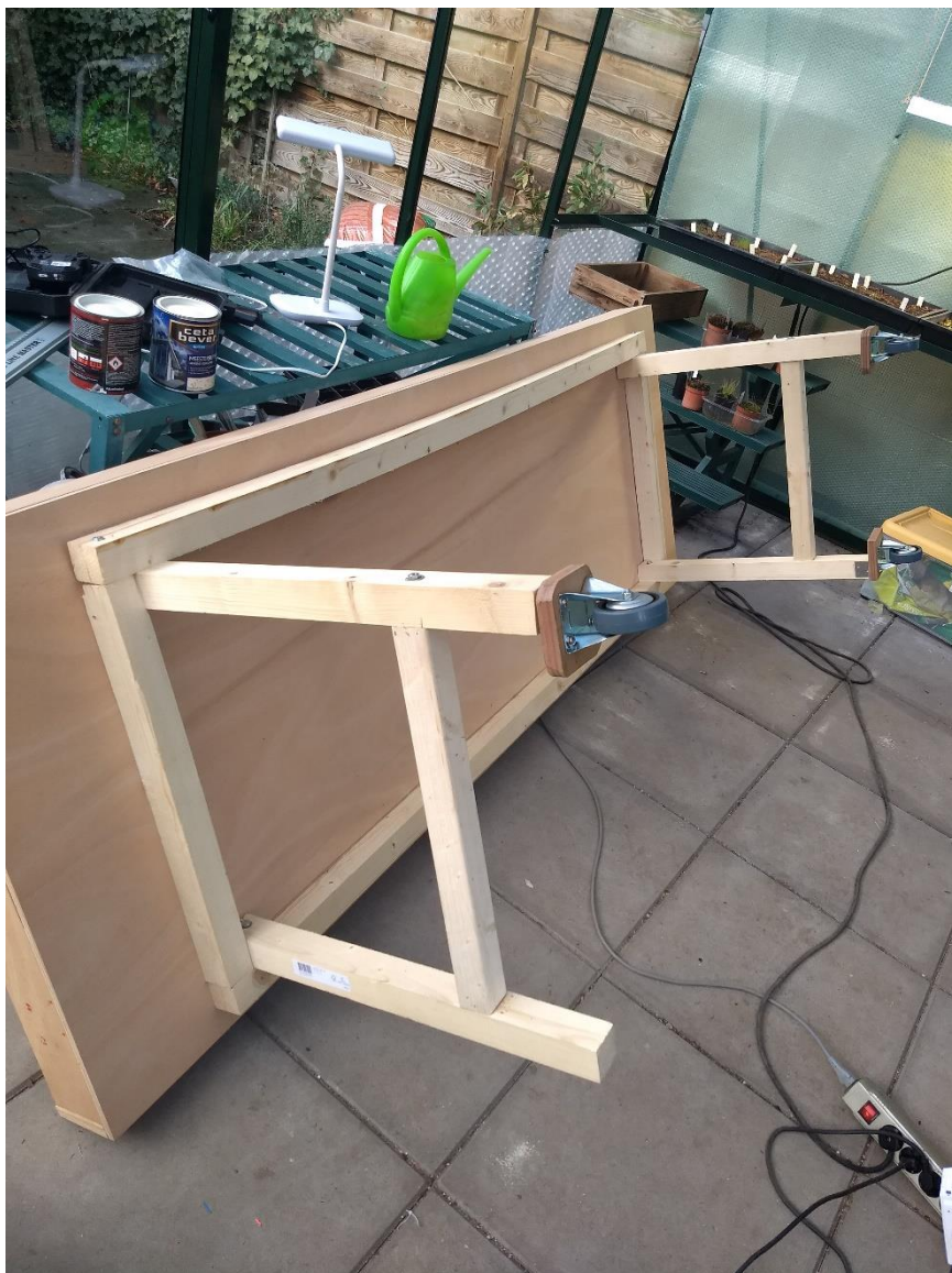
Onderkant tablet met poten zonder steunbalkjes en met geschroefde wieltes op plaatjes.
